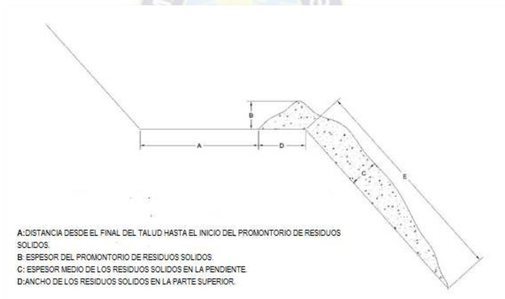
*Figura 9: Sección típica con vertido de residuos sólidos*
