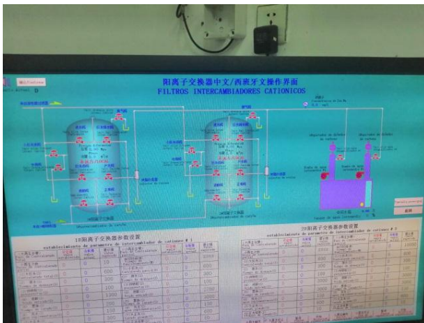
Foto 8: Pantalla de control columnas de carbon activado y columna catiónica
