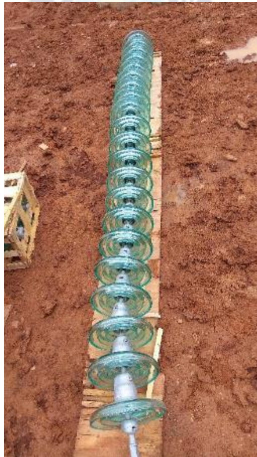
Figura 44 - Cadena de aisladores de vidrio, empleado S/E Mazocruz
