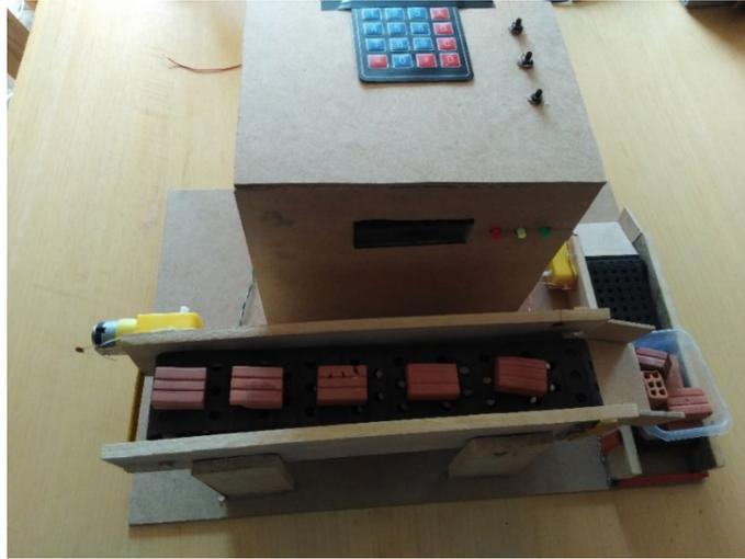
Figura 3.5 Maqueta de banda transportadora
