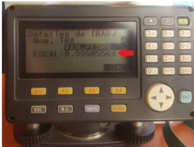
Figura 70. Cálculo del factor combinado e introducción del factor a la estación total
