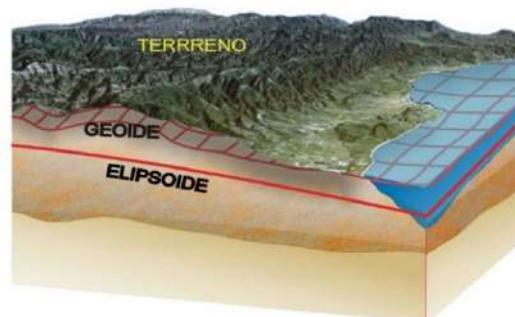
Figura 7. Superficie topográfica
