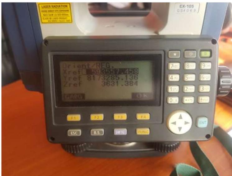
Figura 76. Introducción de las coordenadas del punto de orientación del equipo GPS-2 y verificación del cierre del punto de orientación.
