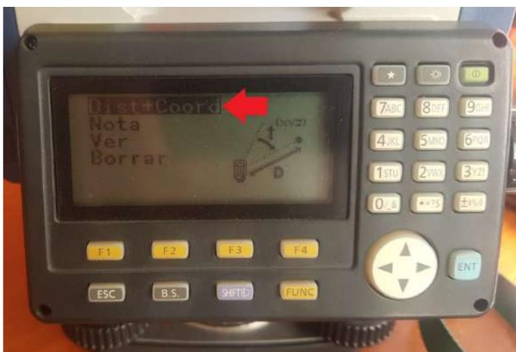
Figura 77. Selección del menú DIST+COORD para el inicio del levantamiento topográfico georreferenciado
