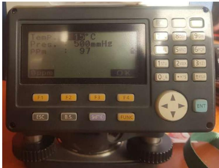
Figura 74. Introducción de los datos de temperatura, presión al equipo
