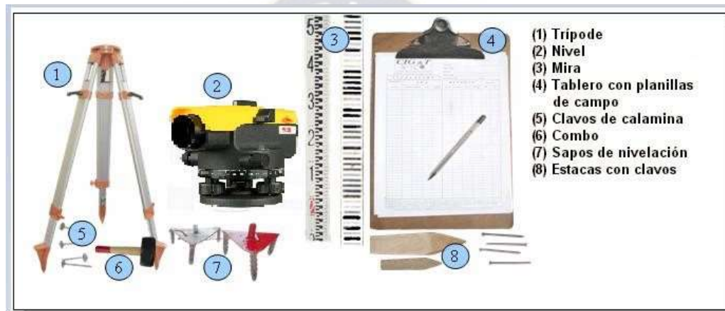
FIGURA 3. 4. Equipo básico para nivelación
