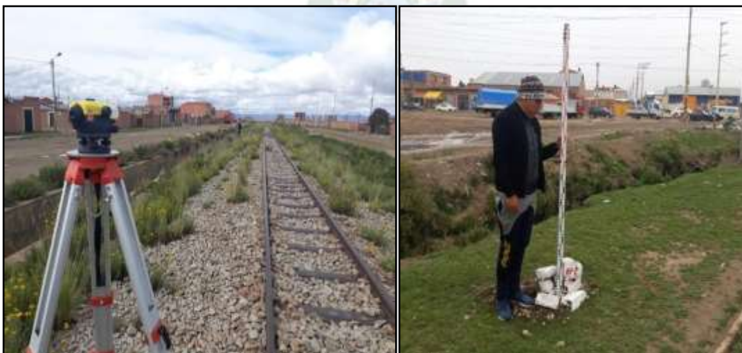
FIGURA 3. 3 Realizando las lecturas con el NIVEL LEICA NA532
