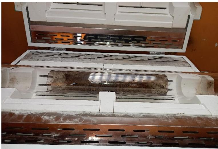
**Figura 3.2** Materia prima cargada en horno de pirólisis.
