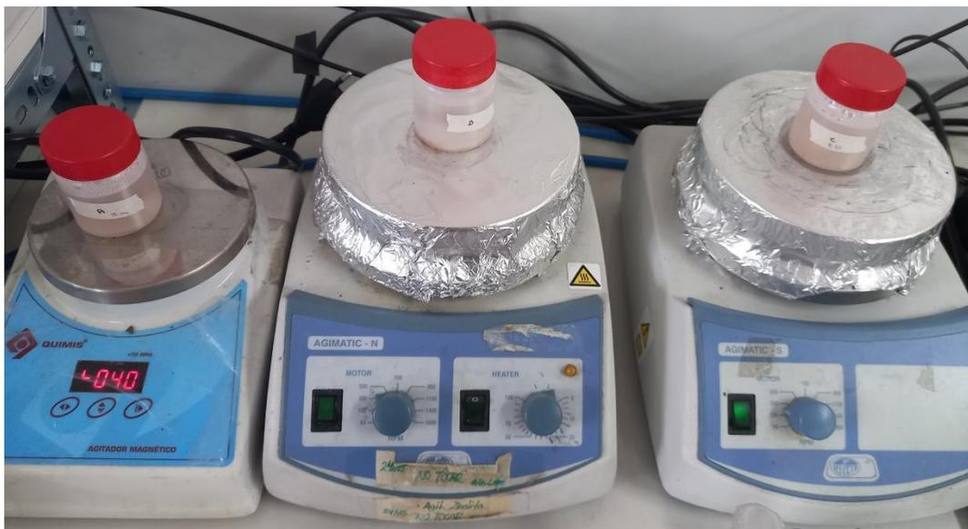
Figura 3.5 Sistema de adsorción – pruebas a nivel batch
