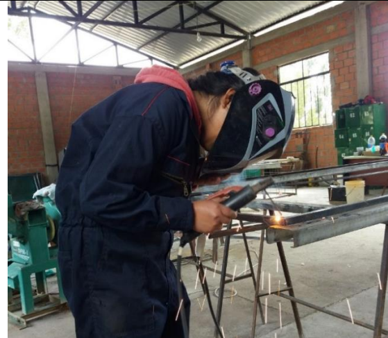
Soldando la estructura hidropónica
