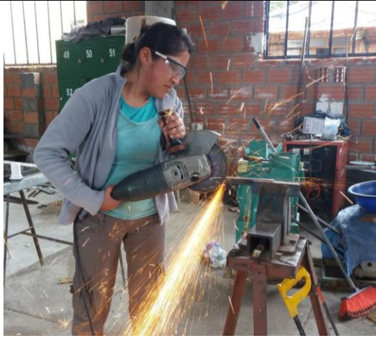
Cortado de las piezas metálicas
