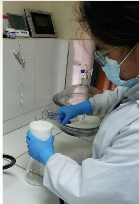
Filtrar las muestras en el equipo de filtración
