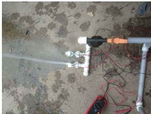
Figura 16 Funcionamiento de la electroválvula
