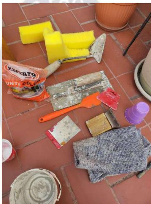
*Ilustración 36 Materiales empleados en reparación de socalo*
