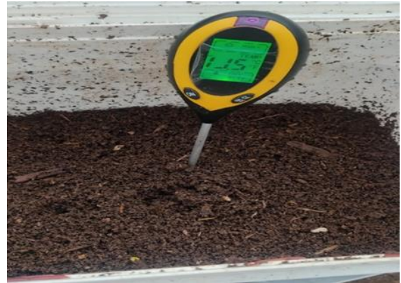
Fotografía 20. Medición de temperatura del sustrato con termómetro digital
