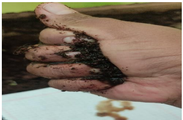
Fotografía 22. Evaluación de la humedad con el método del puño
