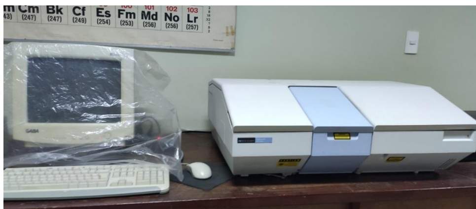
Fotografía 25. Espectrómetro visible-uv BIOCHROM de barrido-Libra
