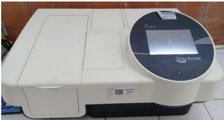
Fotografía 24. Espectrómetro visible-uv BIOCHROM de barrido-Libra
