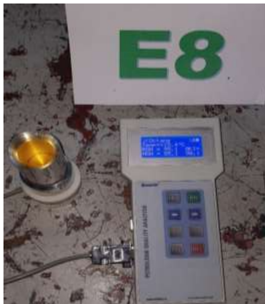
Figura 25 Octanaje de combustible GASOLINA ESPECIAL (E8).
