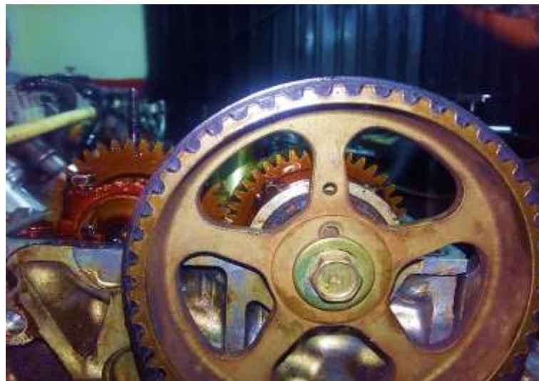
Figura 15 Sincronizado de motor Toyota 5A
