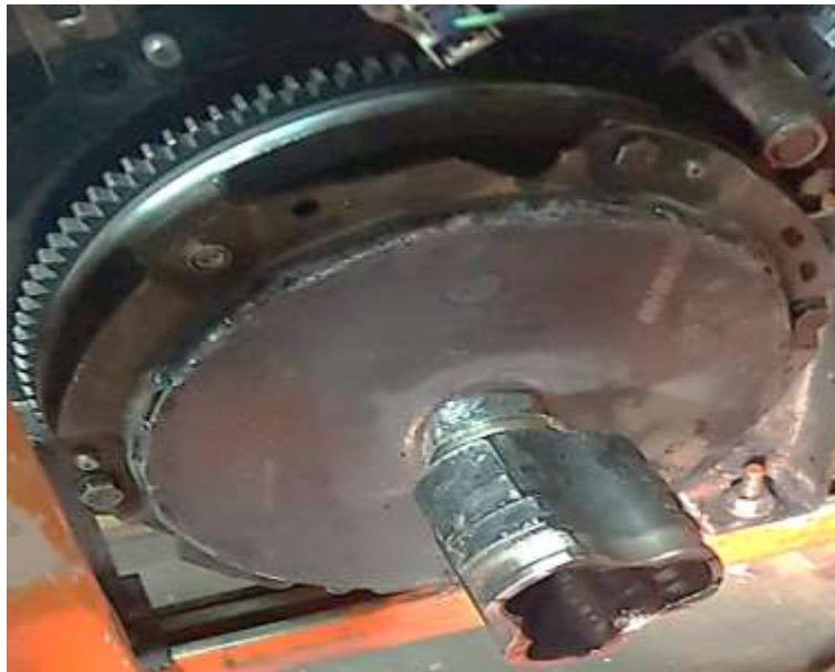
Figura 30 Montaje del acoplamiento fabricado para el motor.
