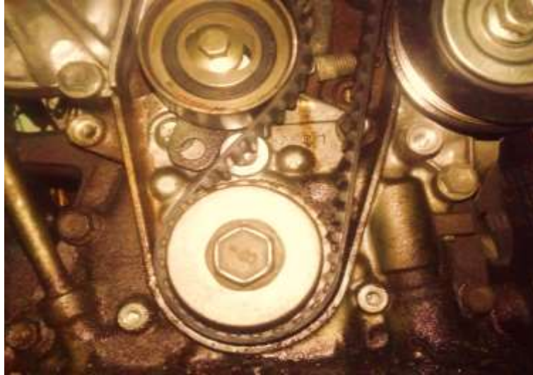
Figura 16 Sincronización de motor Toyota 5A
