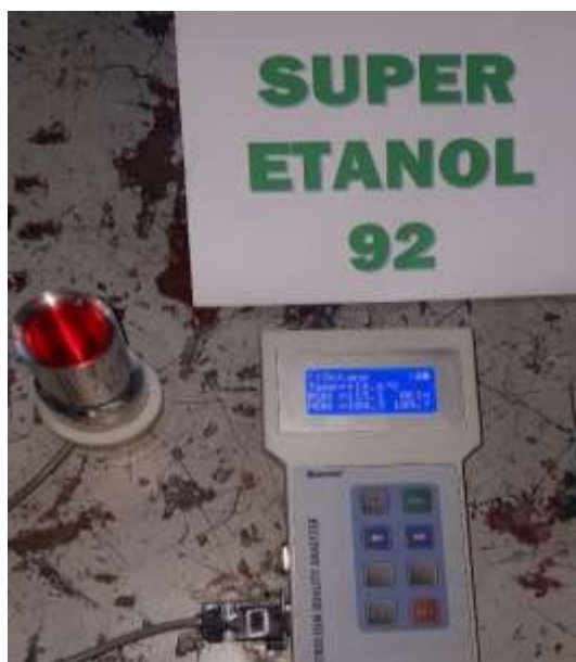
Figura 26 Octanaje del combustible (SUPER ETANOL 92).
