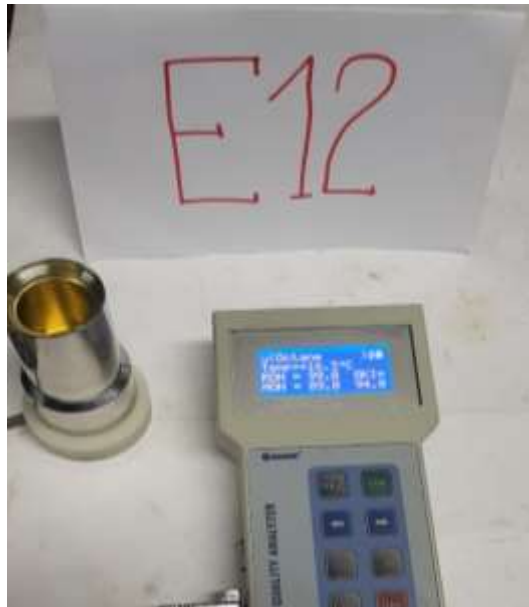
Figura 27 Octanaje de las mezclas (E12).
