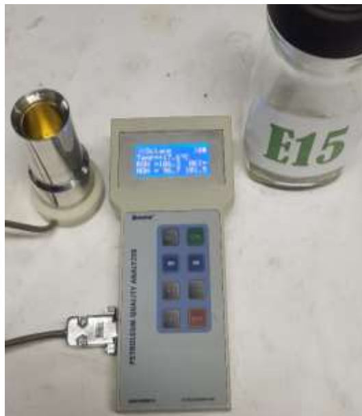
Figura 28 Octanaje de las mezclas (E15).
