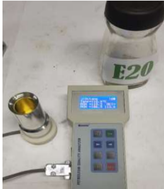
Figura 29 Octanaje de las mezclas (E20 ).
