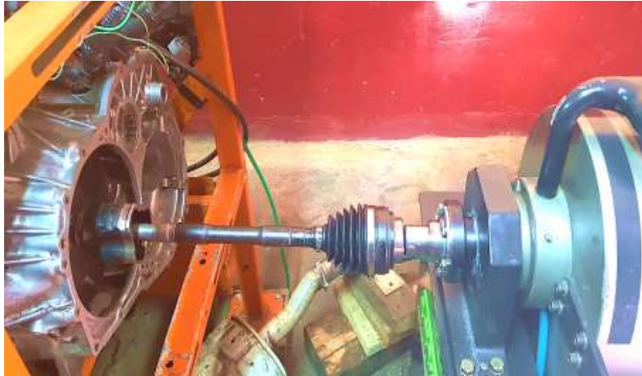
Figura 31 Acoplamiento del motor al banco de prueba accudyno.
