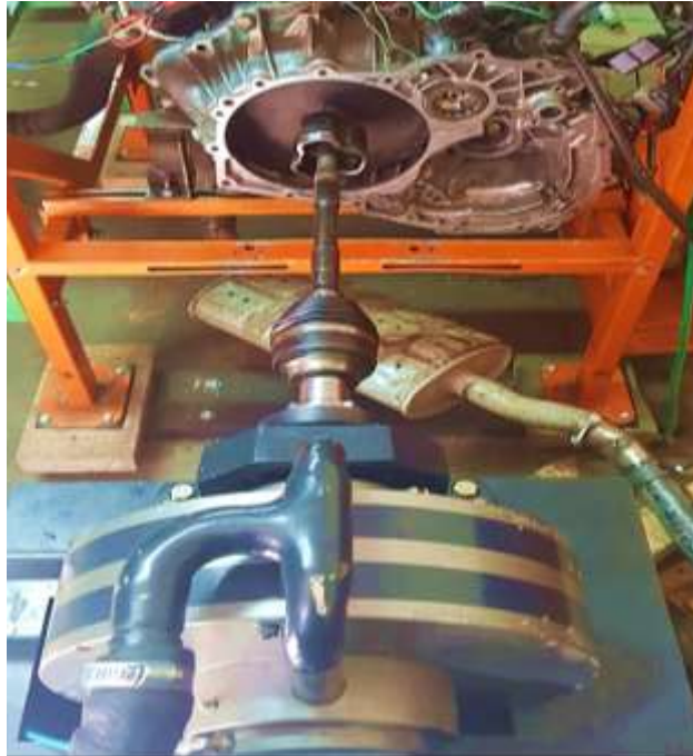
Figura 34 Motor y banco dinamométrico acoplado.
