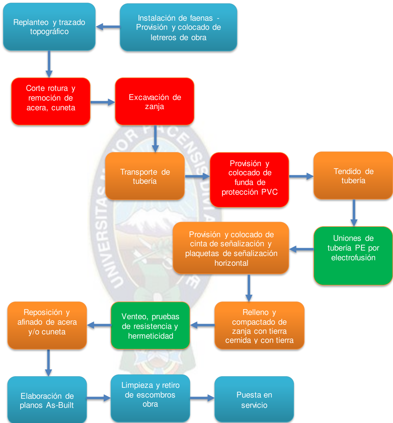
Figura 4.1 Procesos de Construcción de Red Secundaria
