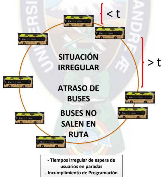
Figura 3: Situación Irregular de la Operación
