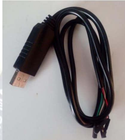
Figura 96. Cable PL2303 para conexión de Hardware con la GUI. Fuente: Elaboración propia.
