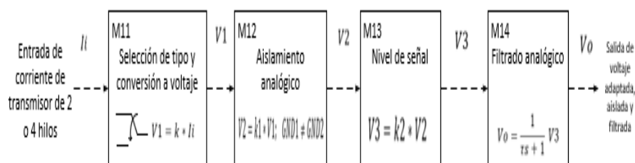
Figura 62. Submódulos para entrada de transmisor de 2 o 4 hilos.
