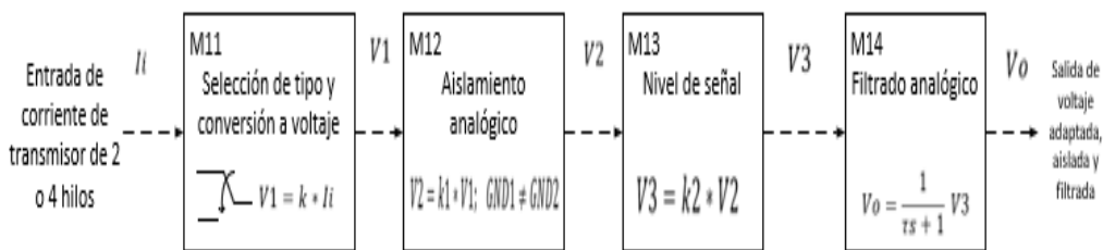
Figura 38. Submódulos para entrada de transmisor de 2 o 4 hilos.
