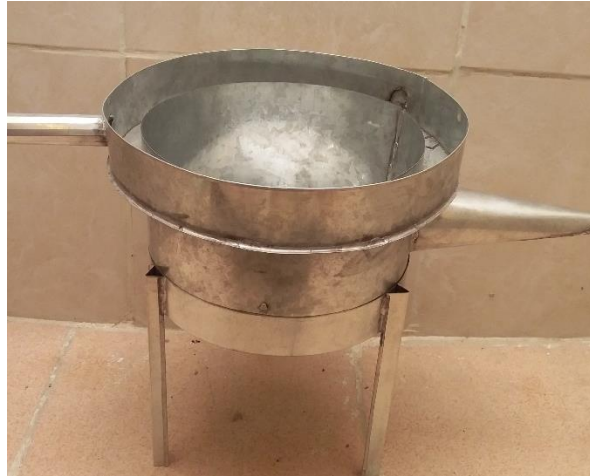
Fuente: Vista Frontal del sedimentador prototipo. Elaboración propia
