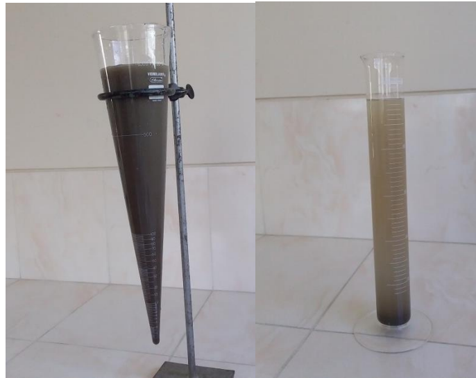
Figura 15. MONTAJE DEL SISTEMA DE SEDIMENTACIÓN
