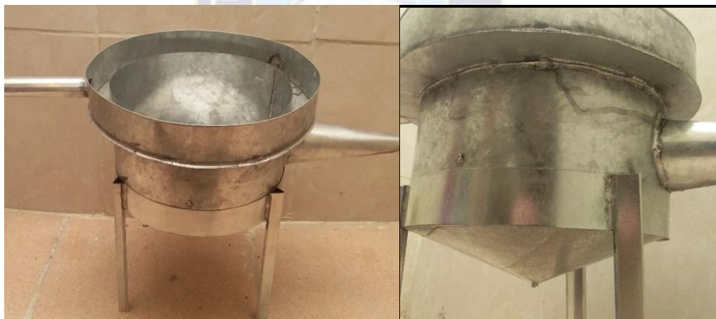
Figura 32. SEDIMENTADOR CONSTRUIDO A ESCALA LABORATORIO
