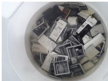
**Figura 3.2.** Descarga de baterías de Ion Lítio
