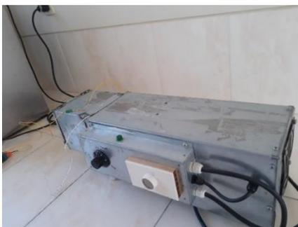
**Figura 3.8.** Secador de bandejas
