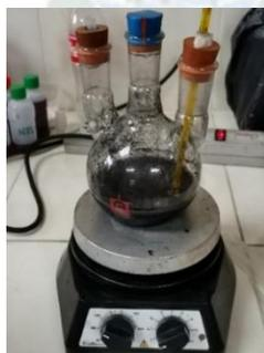
**Figura 3.10.** Balón de tres bocas para realizar pruebas experimentales de lixiviación
