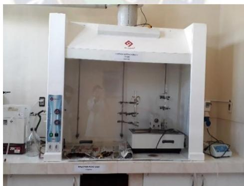
**Figura 3.4.** Cámara extractora de gases donde se lleva a cabo el proceso de desmantelamiento
