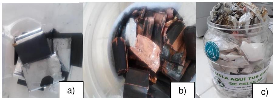
**Figura 3.5.** Componentes de las LIBs: a) Cátodo, b) Ánodo, c) Separador (plástico)
