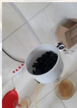
**Figura 3.7.** Filtración de material catódico
