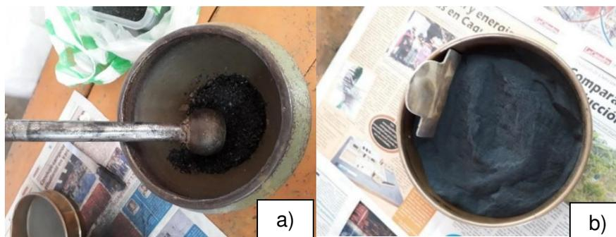
**Figura 3.9.** a) Molido de material catódico. b) Tamizado de material catódico
