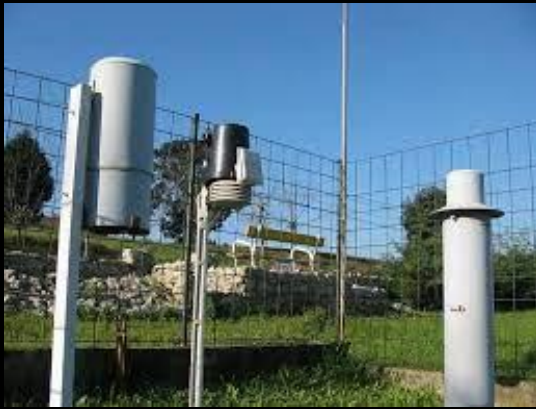
Recipiente abierto a los lados verticales para medir la lluvia.
