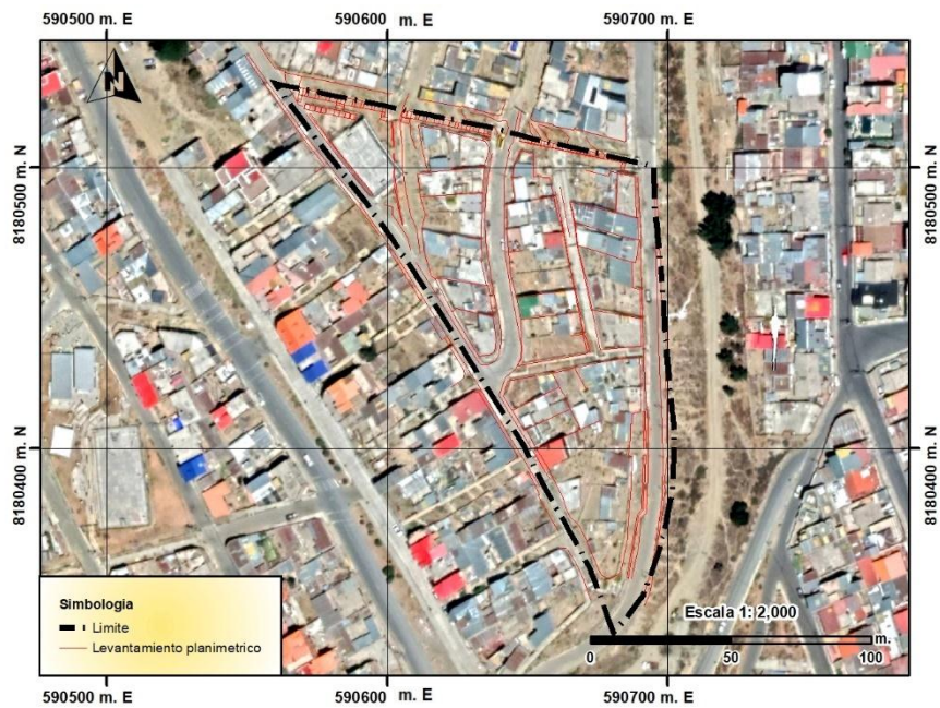
Figura 62 – Sobreposición de levantamiento topográfico con imagen satelital Google 2020 (mayo)
