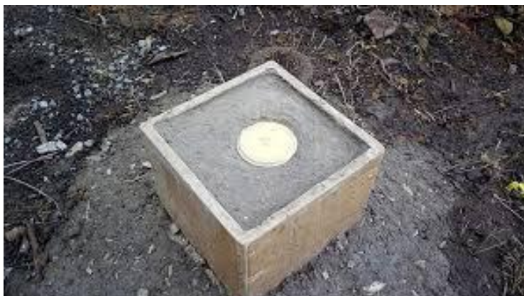
Figura 33 – Modelo de mojón de cemento empleado para materialización de punto de control geodésico
