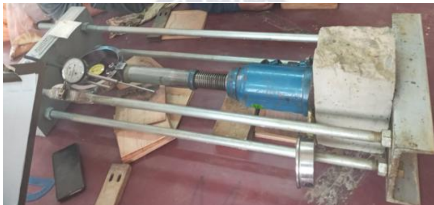
Figura 3.29 Calibración de gato hidráulico.
