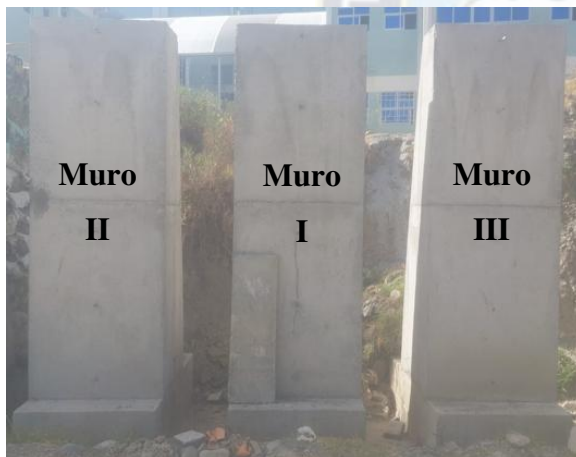
Figura 3.1 Vista lateral y frontal de los muros de hormigón ciclópeo pet.
