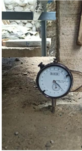
Figura 3.31 Disposición de extensómetros. “E2” Zapata – Medición vertical
