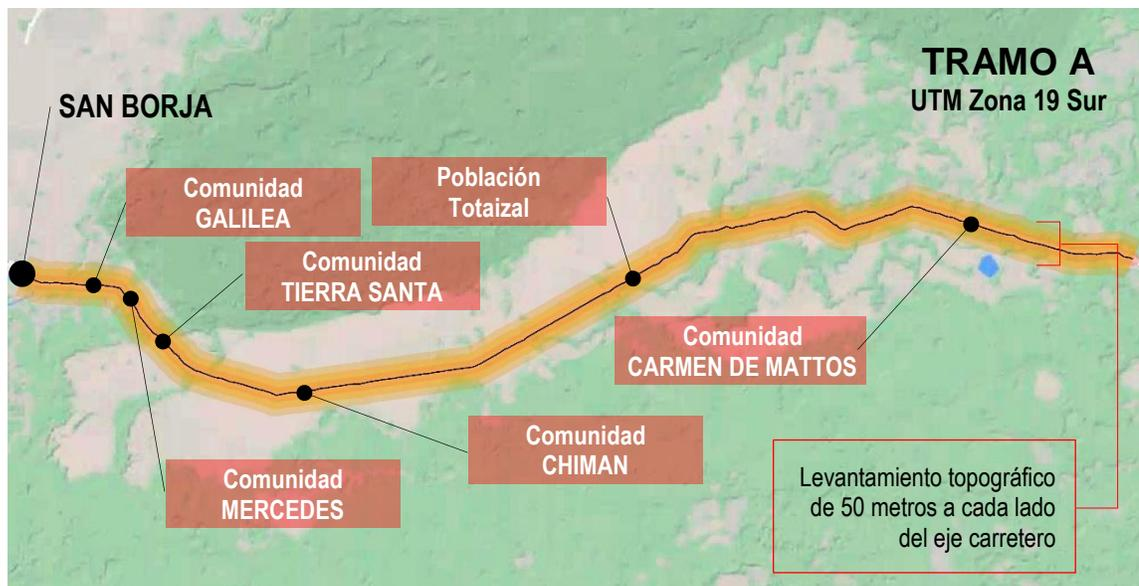
Figura No. 48 - Levantamiento topográfico del tramo A
