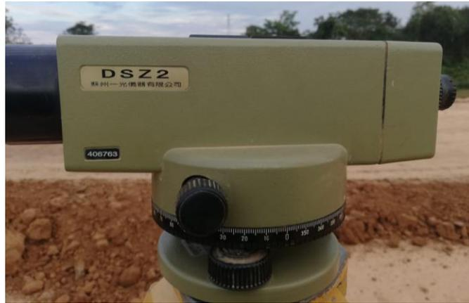
Fotografía No. 15 - Equipo empleado durante nivelación geométrica en campo
