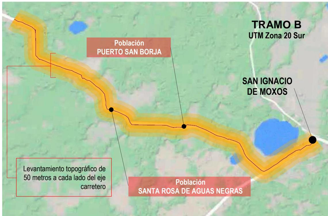
Figura No. 49 - Levantamiento topográfico del tramo b
