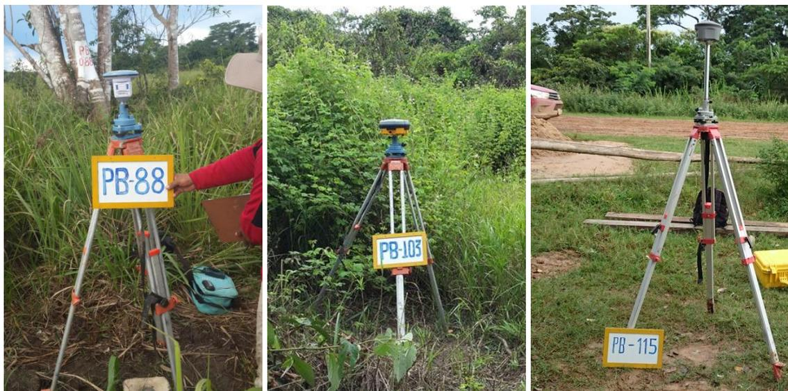
Fotografía No. 11 - Densificación de puntos de control GNSS días 7, 8 y 9
