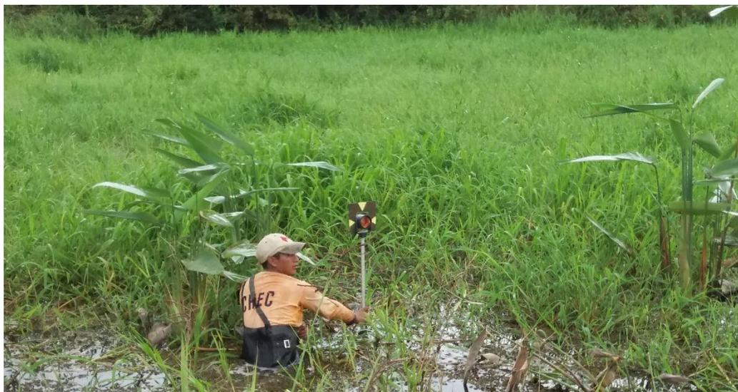
Fotografía No. 19 - Levantamiento topográfico de humedales
