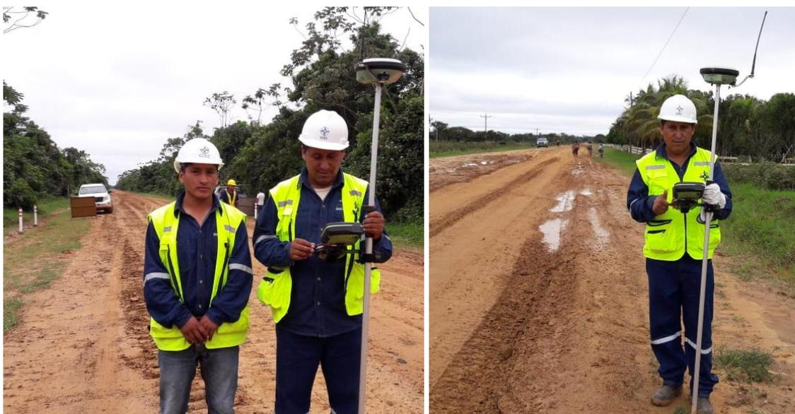
Fotografía No. 12 - Densificación de coordenadas de BM's con equipos GNSS RTK
