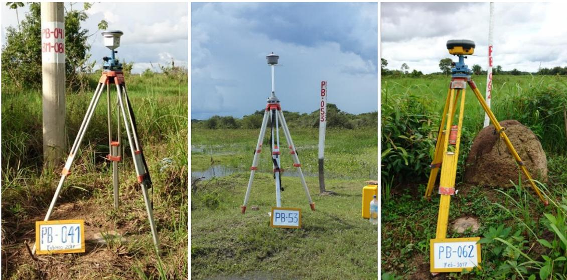
Fotografía No. 10 - Densificación de puntos de control GNSS días 4, 5 y 6
