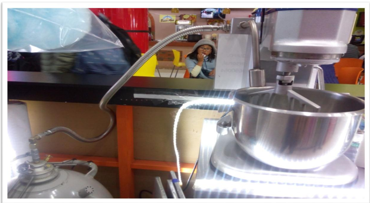
Tanque de nitrógeno líquido conectado a la batidora
