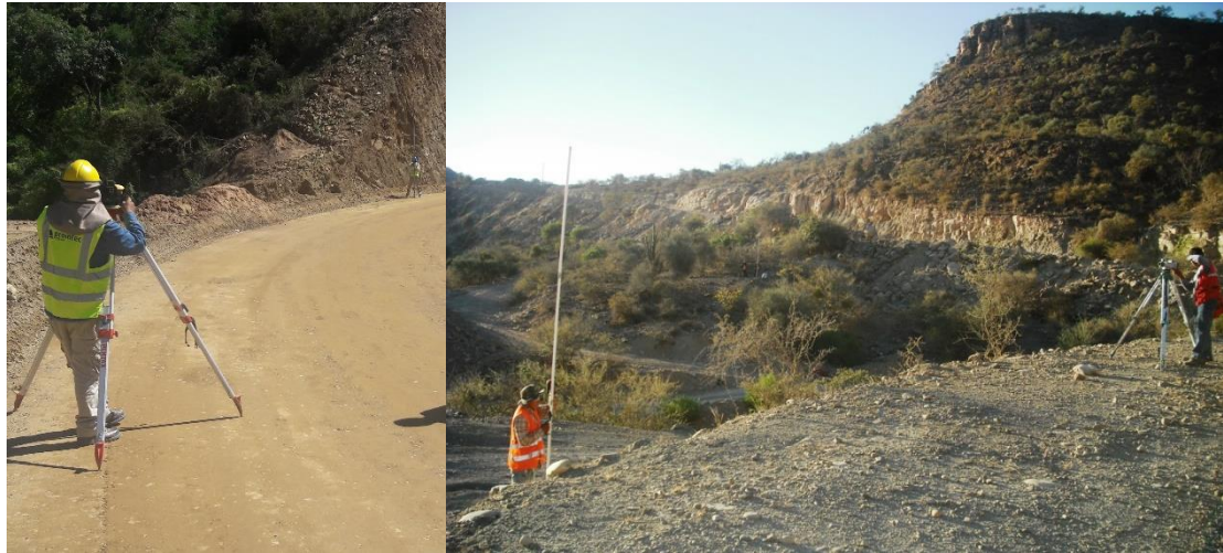
Figura No. 43 - Control de nivelación geométrica de Pares Geodésicos y BM's Fuente. Elaboración propia
