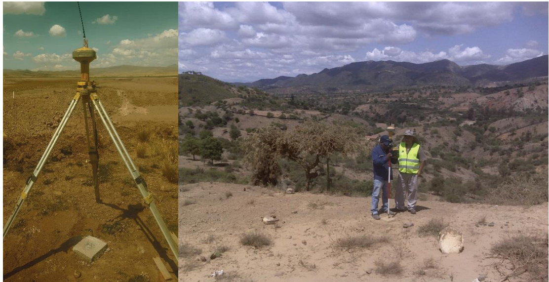
Figura No. 45 - Mensura de puntos de control horizontal Fuente. Elaboración propia
