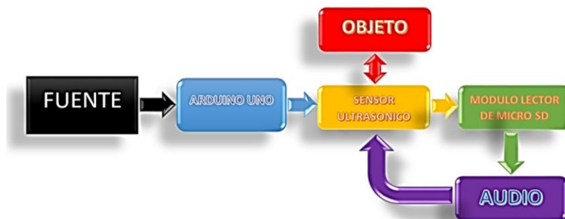
Figura 23. Diagrama de bloques, funcionamiento del prototipo.
