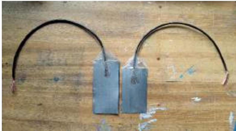
Figura 51. El Aislado de la Cara Posterior de las Placas Positivo y Negativo Utilizando Cinta Adhesiva
