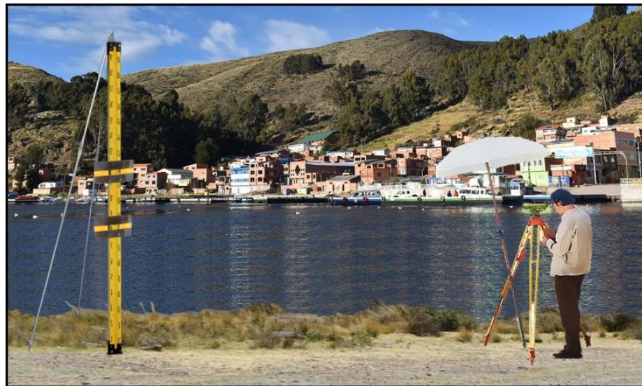
Figura 36: Colocación de tablillas en miras.
