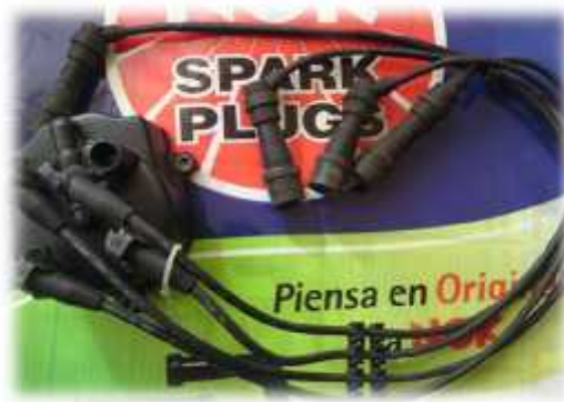
Figura 16: Cables de alta tensión
