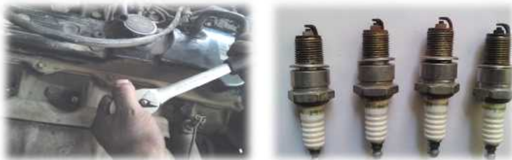
Figura 29: Desmontaje de las bujías
