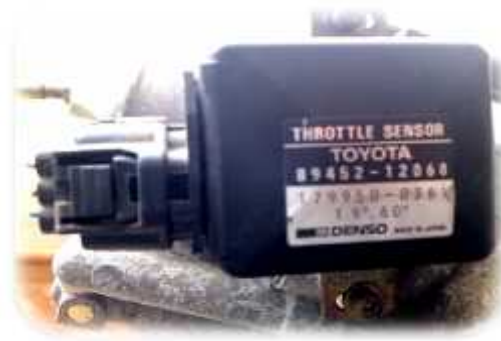
Figura 10: Sensor de posición de la mariposa
