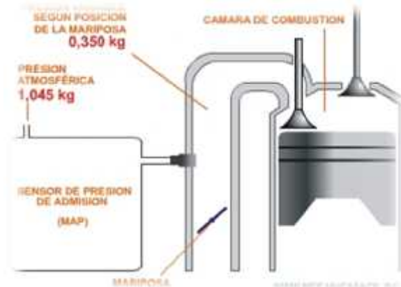
Figura 12: sensor de presión del múltiple de admisión
