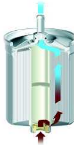
Figura 3: Filtro de combustible
