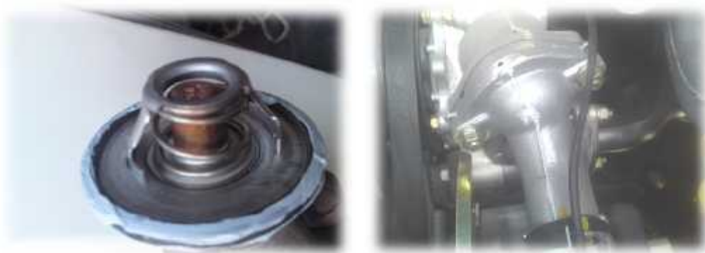
Figura 78: Armado del termostato con silicona
