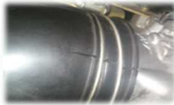
Figura 19: Fuga de aire en el cuerpo de acelerador
