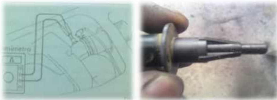
Figura 70: Verificación del sensor de temperatura
