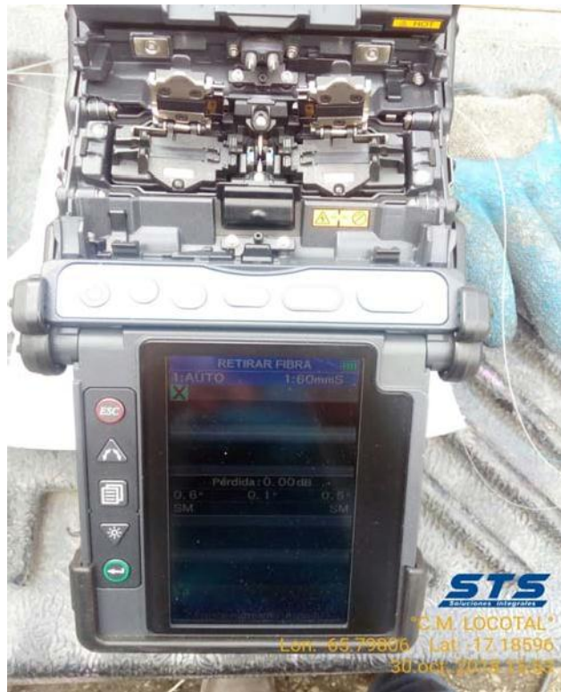
Figura 26. Equipo fusionadora FUJIKURA 70S con fusiones de pérdida de 0.00 dB.
