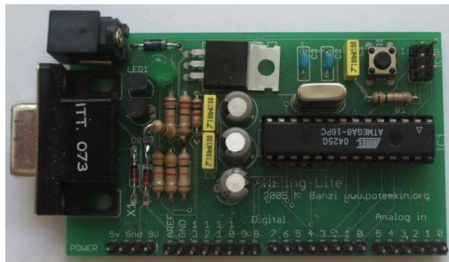
**Figura 2.15** Primera placa arduino
