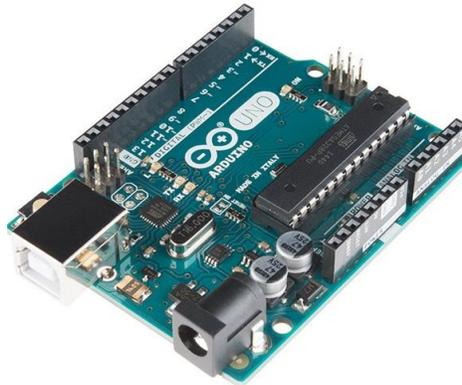
**Figura 2.16** Placa Arduino UNO R3
