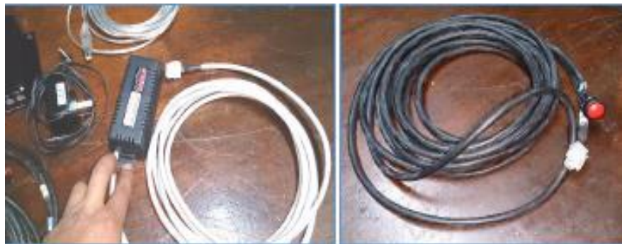
Figura 29. Central atmosférica y cable de comunicación
