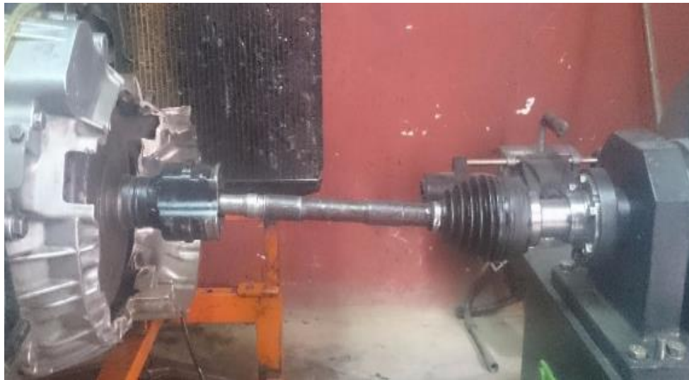
Figura 33. Acoplamiento del motor al dinamómetro con una junta homocinética
