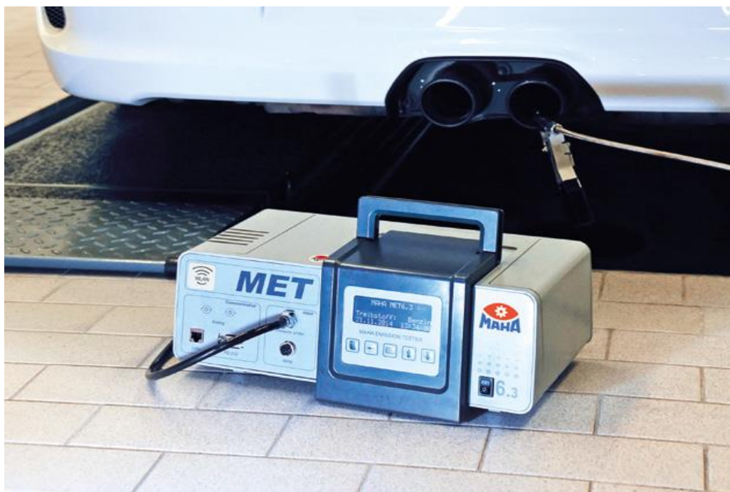
Figura 9. Analizador de los gases de escape
