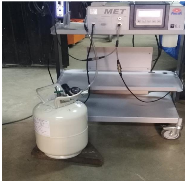
Figura 19. Instalación del equipo analizador de gases con el gas de calibración
