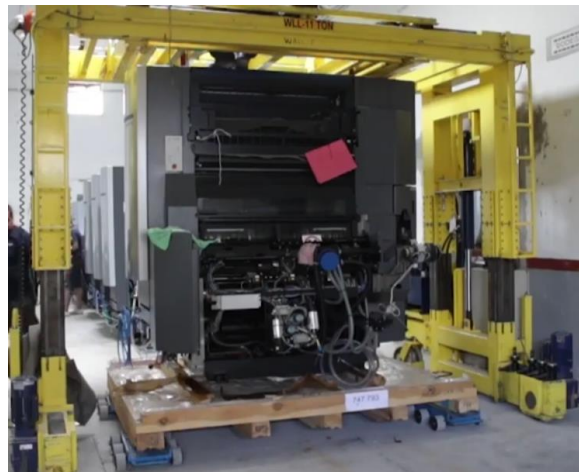
Fig.7 Transporte y posicionamiento de cuerpos impresores
