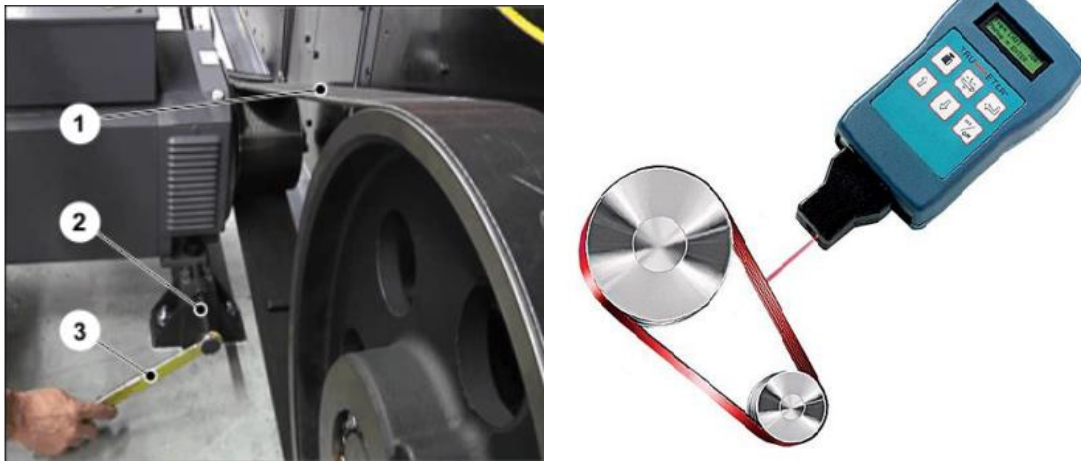
Fig. 27 Tensado de la correa trapezoidal con dentado interior
