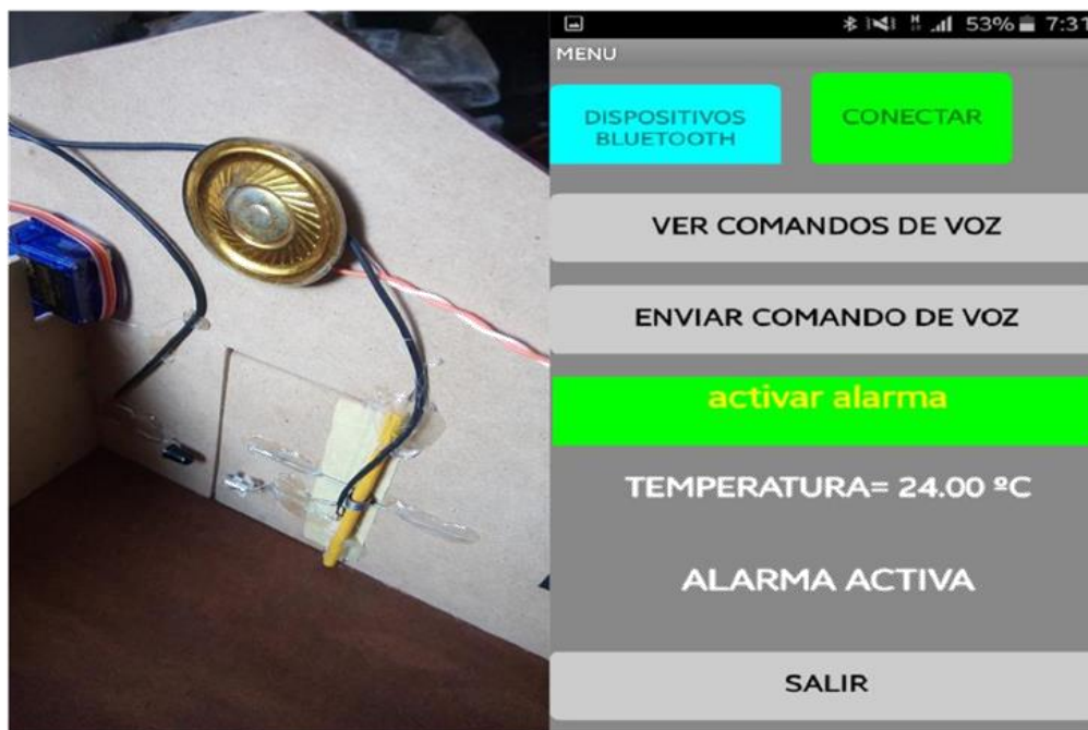
28-Figura 28: Sensor de apertura activado desde un dispositivo móvil
