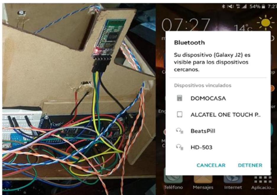
27-Figura 27: Vinculación del Módulo Bluetooth HC-05 con el dispositivo móvil
