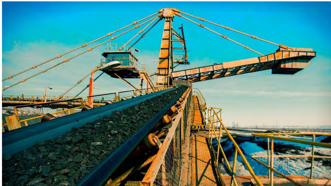
Producción S. Cielo abierto – alta tecnología: correas o cintas transportadoras (fuente Min. de Minería)
