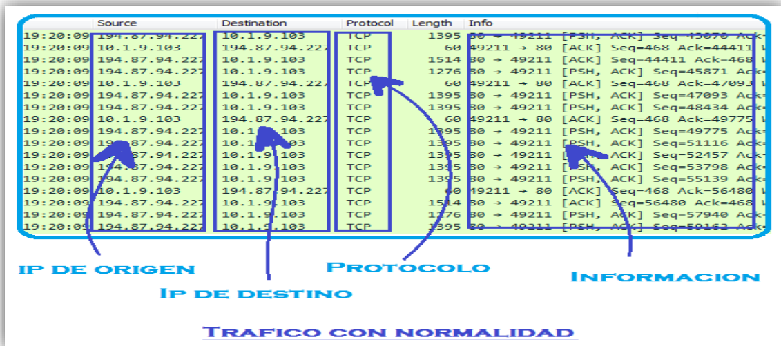
Figura 3.4. El flujo del tráfico de red, utilizando la herramienta de Wireshark.
