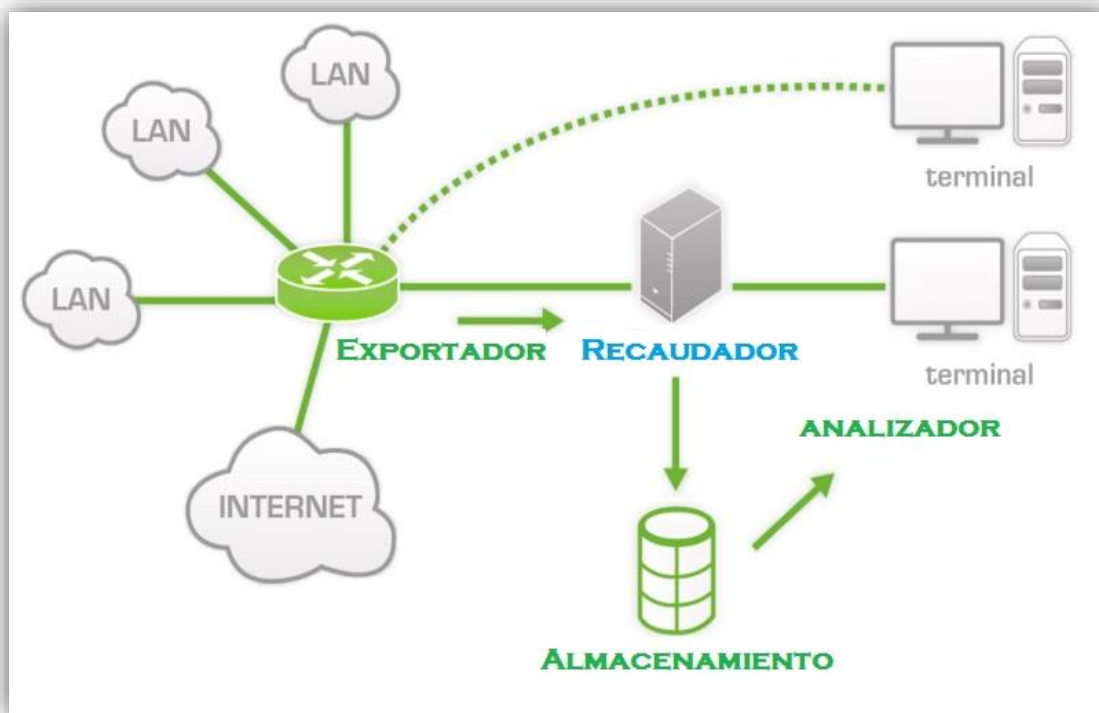
Figura 3.7. Dos formas de obtener una terminal, insertándolo directamente al router (Exportador) y otra forma insertándolo al servidor (Recaudador).
