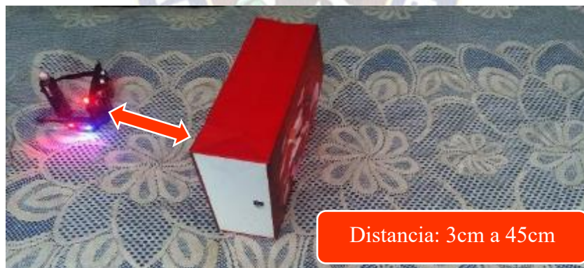
Figura 3. 22 Detección de Obstáculos por la Derecho en el Rango de la Distancia 1
