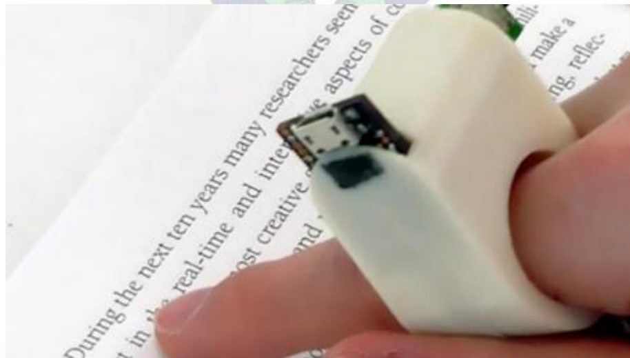
Figura 2. 21 Anillo a Través de una Cámara para Leer con una Voz Sintetizada
