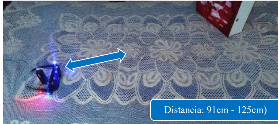
Figura 3. 21 Detección de Obstáculos por la Izquierda en el Rango de la Distancia 3
