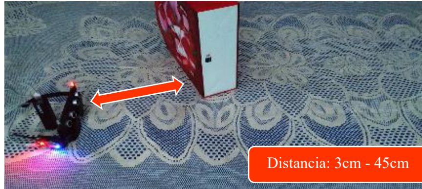
Figura 3. 19 Detección de Obstáculos por la Izquierda en el Rango de la Distancia 1
