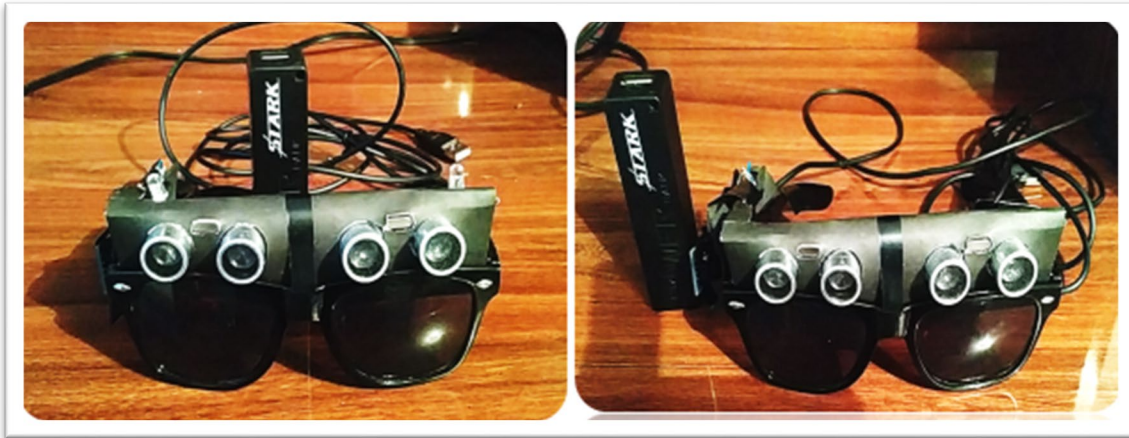
Figura 3. 15: Prototipo de Gafas con Leds y sin Leds utilizados para las Pruebas de Funcionamiento
