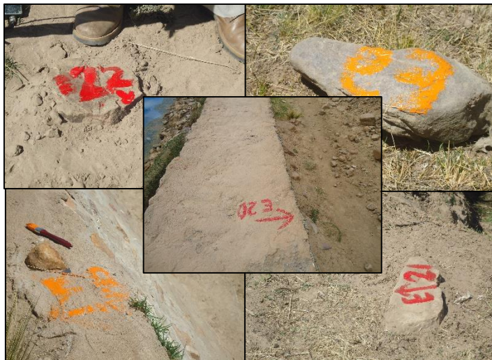
Fotografía 9: Señalización de los puntos de la poligonal
