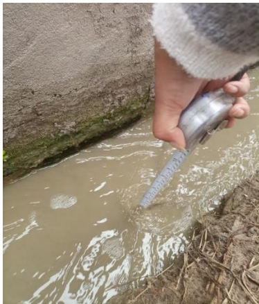
Fotografía 20. Toma de datos de la profundidad del canal
