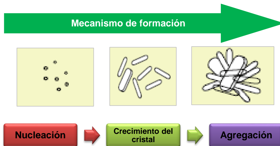
Figura 5. Ilustración esquemática del mecanismo de formación de la estruvita a pH constante Fuente: modificado de Ye, et.al., 2014
