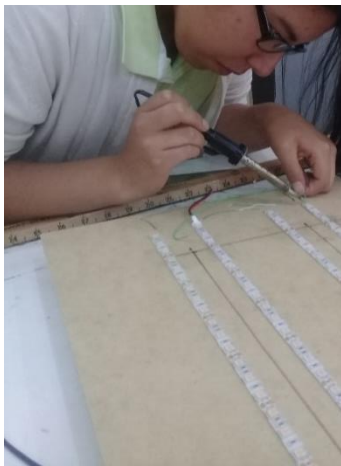
Figura 29: Soldado de luces con los cables, se realizó una soldadura para conectar los cables de cinta led a cinta led.
