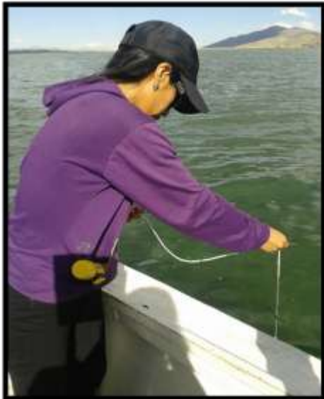
Figura Nº 16 (Izq.) y Figura Nº 17 (Der.) Toma de datos con sonda FluoroProbe BBE.
