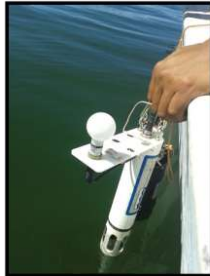
Figura Nº 16 (Izq.) y Figura Nº 17 (Der.) Toma de datos con sonda FluoroProbe BBE.
