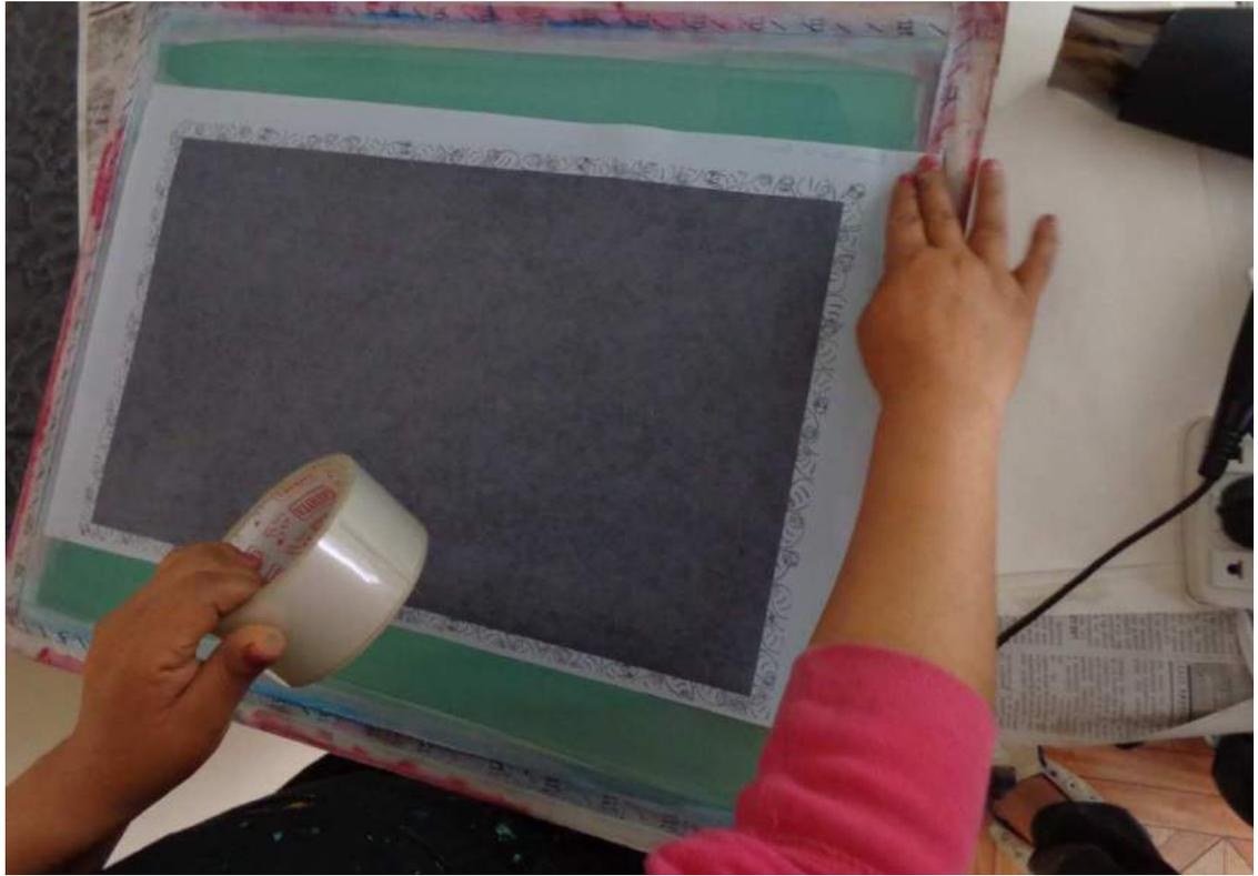
Preparación de la malla para el quemado y posterior revelado de la misma.
