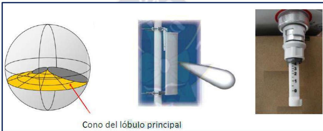
*Figura 3.14. Patrón de Radiación Tilt Eléctrico*
