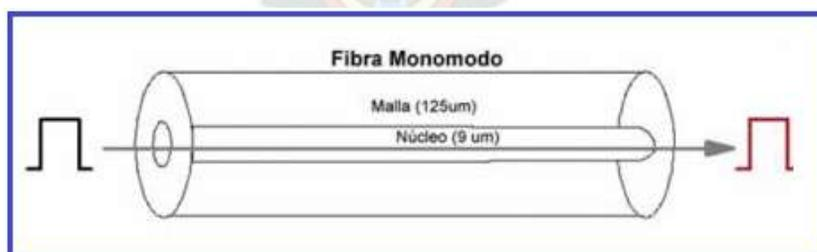
*Figura 3.10.* Transmisión por una Fibra Óptica Monomodo
