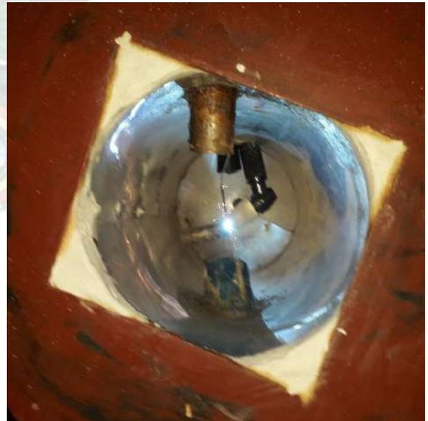
*Sistema de arco de plasma y su conformación dentro del reactor*
