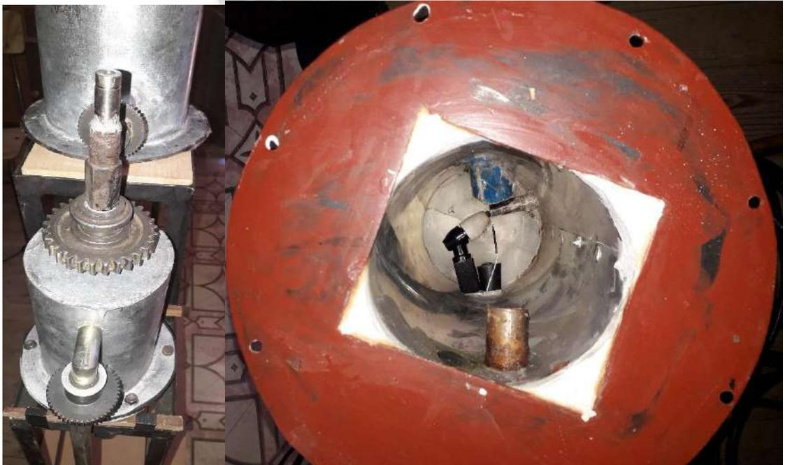
*Armado del sistema de eliminador de partículas (ciclón separador) y el sistema de arco de plasma en el interior del reactor.*
