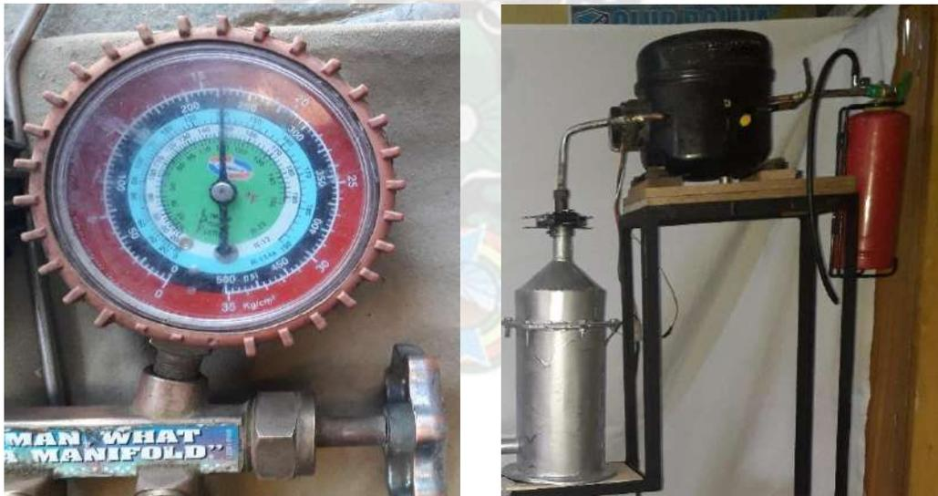
*La presión que alcanza el compresor es de 250 PSI, el gas de síntesis será almacenado a esa presión en el tanque.*
