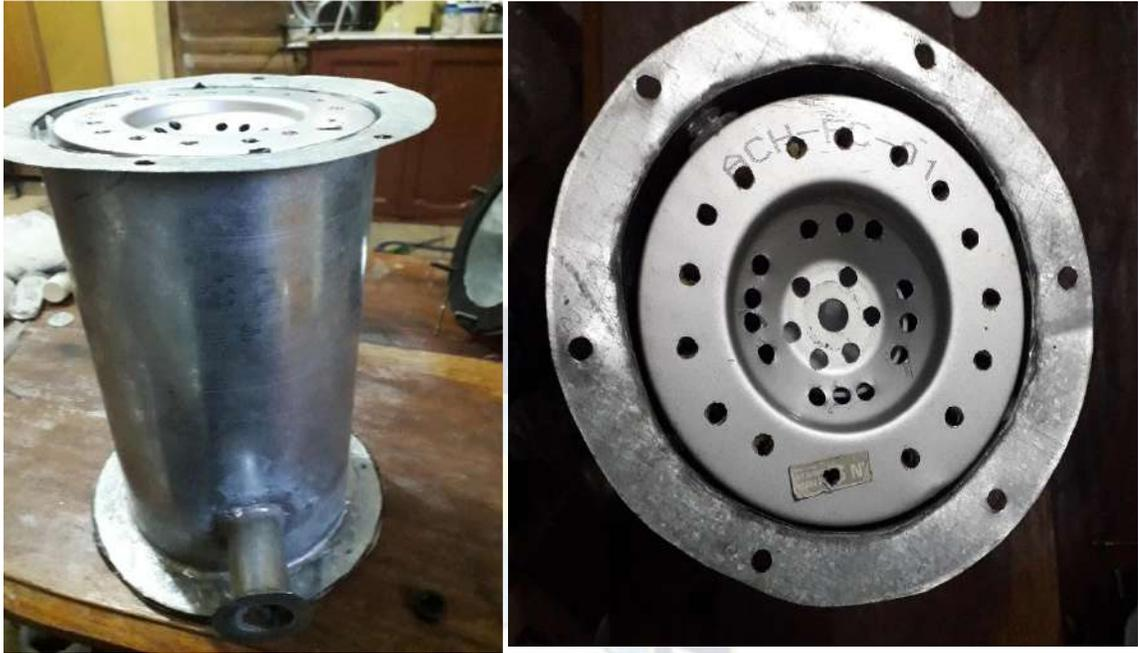
*Armado del filtro de lecho empacado, que en su interior contiene, carbón activado, algodón, y papel filtro bañado en hidróxido de sodio.*
