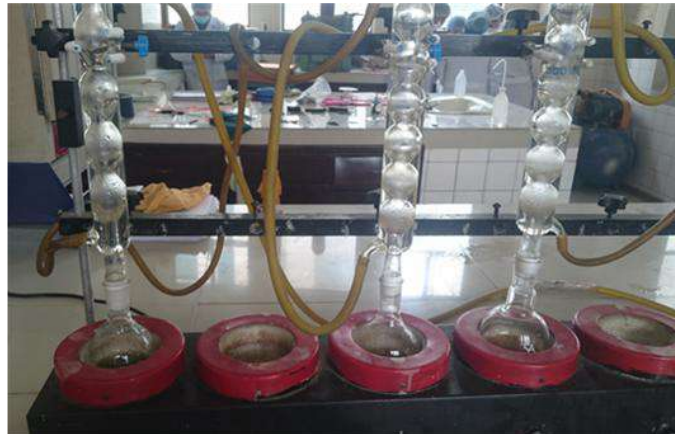
Figura 35 Vista frontal sistema de reflujo abierto
