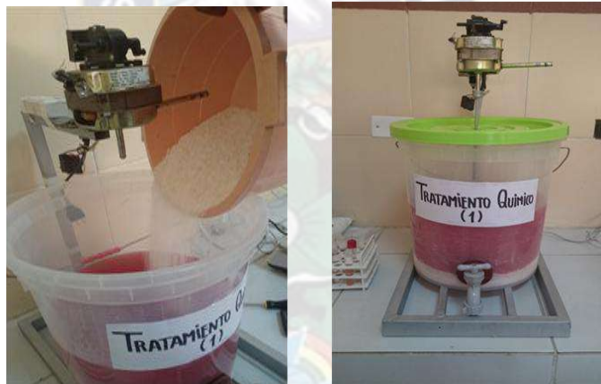
Figura 44 Adición del floculante y agitación a 250rpm
