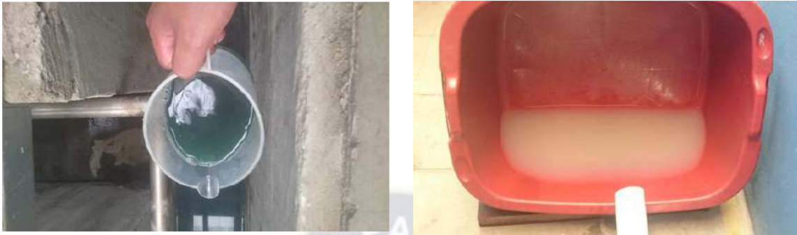
Figura 20 Punto de muestreo 1, salida de la cámara de descarga – punto de muestreo 2, salida de tubería para la medición del caudal
