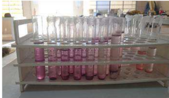
Figura 41 Vista frontal, formación del floculo "agua clarificada"
