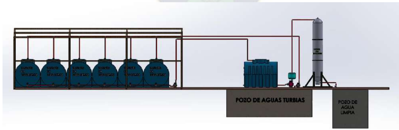
Figura 75 Vista frontal del proceso de tratamiento biológico y físico
