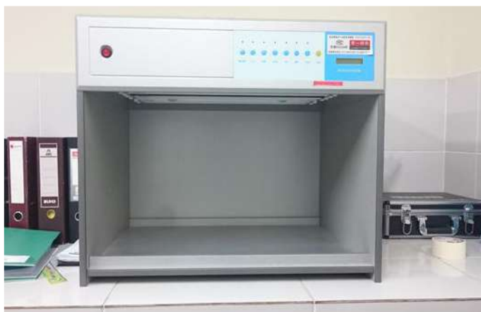
Figura 27 Cabina de luz de laboratorio, para la verificación de color
