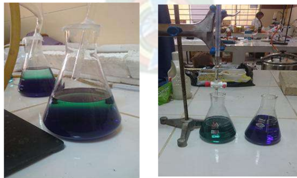
Figura 38 Vista frontal valoración de la muestra con \text{H}_2\text{SO}_4 0,0191 (N)
