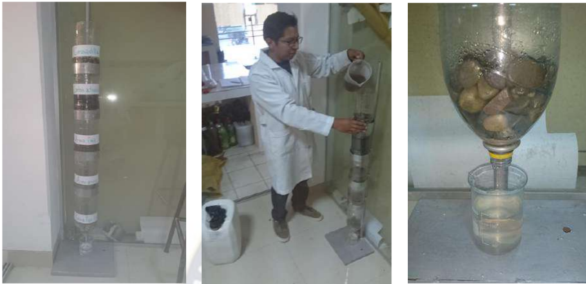
Figura 53 Etapas de tratamiento físico, efluente residual textil clarificado
