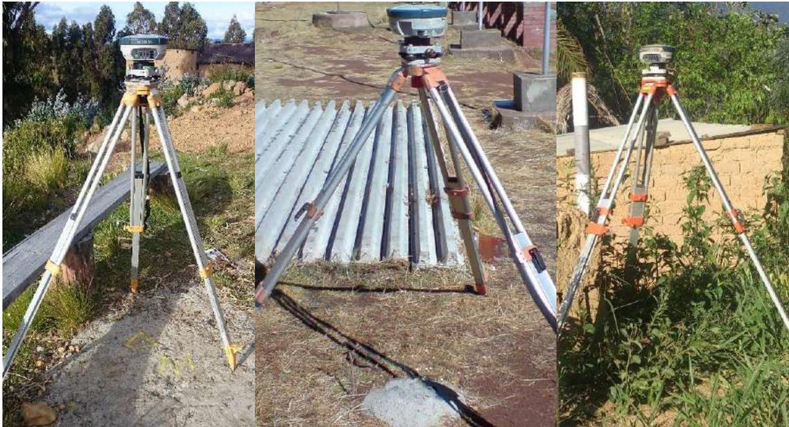
Figura No. 29 - Sesiones simultaneas de receptores GPS/GNSS en campo
