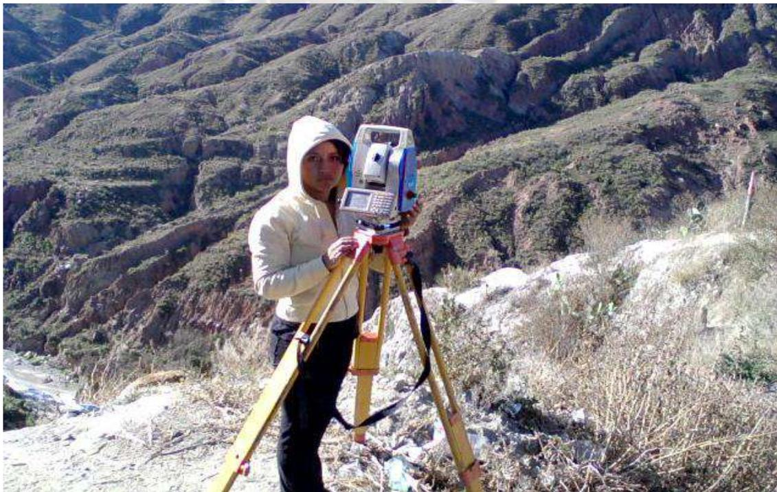
Figura No. 36 - Levantamiento Topográfico en campo
