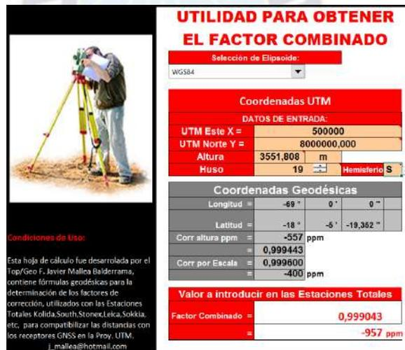
Figura No. 35 - Hoja de Cálculo para obtener el factor combinado
