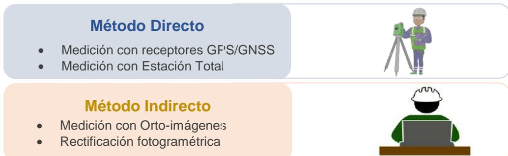
Figura No. 17 - Métodos de levantamiento según INRA
