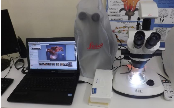
Figura 40. Sistema para obtener las fotografías de los explantes (Estereoscopio + programa de computador)
