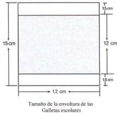
Generalmente las envolturas de galletas de 45 y 50 grs., tienen un formato de 25x15 cm., y no existe una norma exacta a la que se ajusta las envolturas ya que las diferentes empresas aumentan o bien desminuyen de 1 a 2 cm., ya sea en forma horizontal o vertical de las diferentes envolturas existentes.
