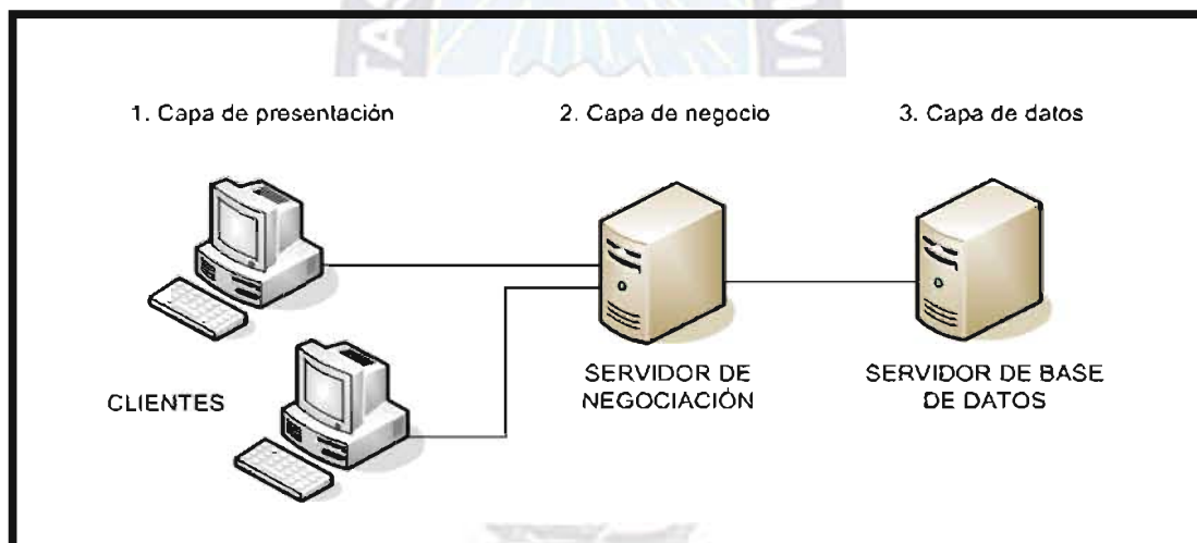
Figura 2.10. Representación el modelo cliente-servidor de 3 capas
